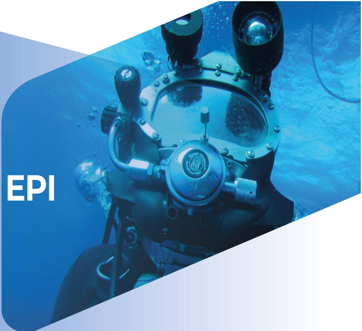
3.1. Todas as operações de mergulho deverão ser realizadas com o uso de capacetes fechados com mecanismo de travamento contra desequipagem inadvertida por duplo pino (neck dam, neck ring e pull pin sleeves). O capacete de mergulho deve ter iluminação, câmera de vídeo colorida e circuito de fonia, todos isolados eletricamente de qualquer contato com o rosto ou a cabeça do mergulhador. A máscara do tipo "full face" deverá ser utilizada apenas pelo mergulhador de emergência / bellman.
