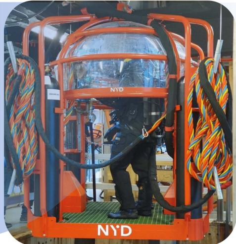
4.21. Aplicar padrões de segurança específicos ao usar equipamentos de içamento para o transporte de mergulhadores devido aos graves ferimentos que podem resultar de quedas. Esses sistemas de manuseio devem ser projetados e certificados para esta finalidade (man ridding). Todo cabo de içamento deve ser fornecido com um certificado de teste confirmando sua carga de trabalho seguro (SWL).
